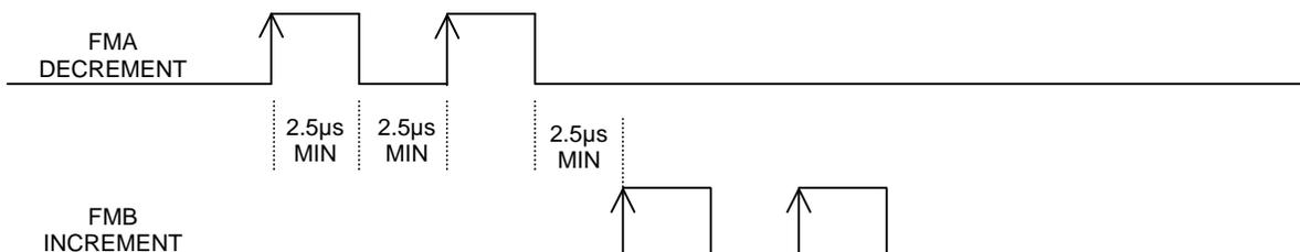
**14.2.1 AUXILIARY ENCODER PULSE INPUTS FMA & FMB (cont'd)**
