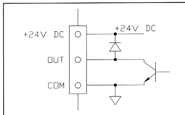
VII. FAULT CODE OUTPUT CIRCUIT
